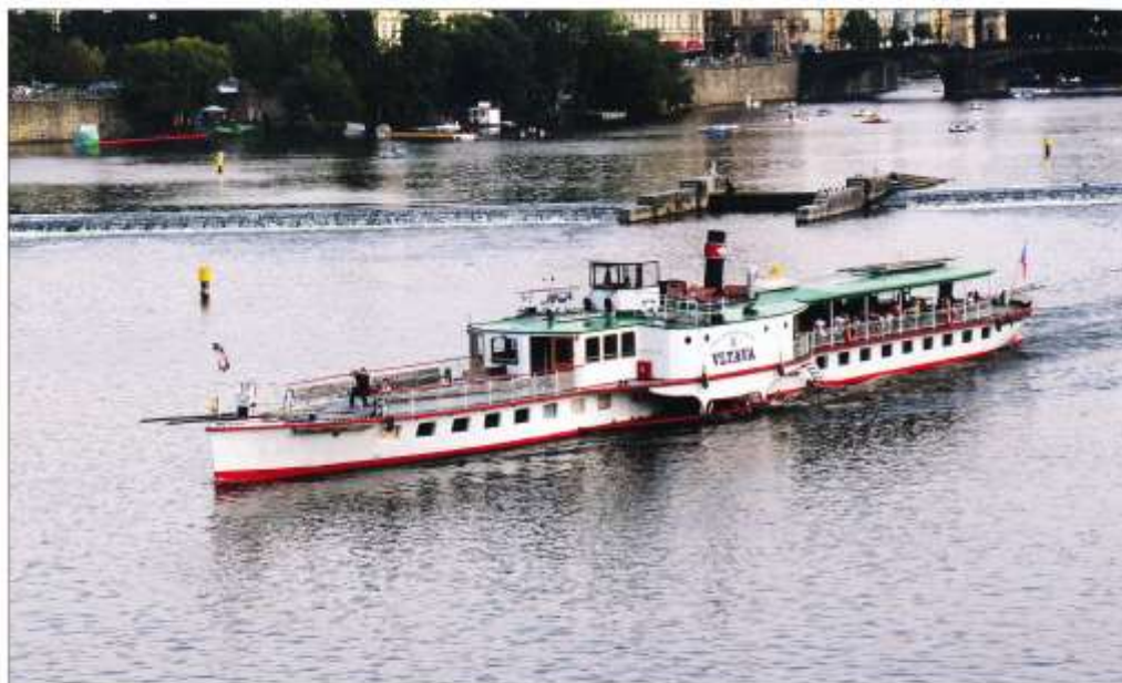
Hjulångaren Vltava passerar under Karlsbron i Prag. Notera de båda långa stövrarna på fördäck, som ibland används för att bl.a. skjuta förskeppet i sidled
