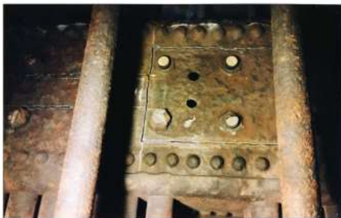
Här syns en bit av flamugnens tak från vattensidan (vattenifrån) i ångpannan ombord i Färjan 4. Foto Gunnar Söderberg 14 november 2017.
