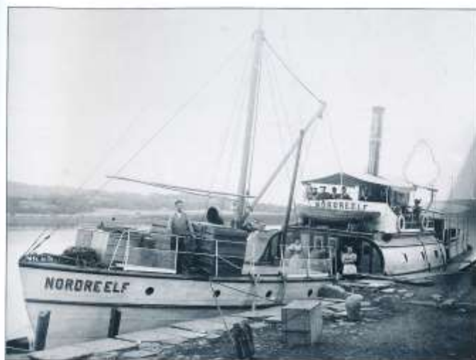
Nordre Elf (I) var byggd 1866, notera den krumma förstären. Den sattes i trafik 1890 på linjen Kornhall-Kungälv-Göteborg för Ångbåts AB Inland och ersattes av ett nybygge 1898. Foto från Torshy, Hårstaads och Lycke Hembryggeriförening.
